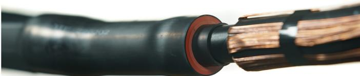
**Capa Interna:** Esta capa está en contacto directo con el cable o el conector. Está hecha de un material elastomérico que tiene excelentes propiedades de aislamiento. La naturaleza elastomérica permite que el material se adapte a los ciclos térmicos del cable, evitando la aparición de una interfaz entre el tubo y el sustrato inferior.
